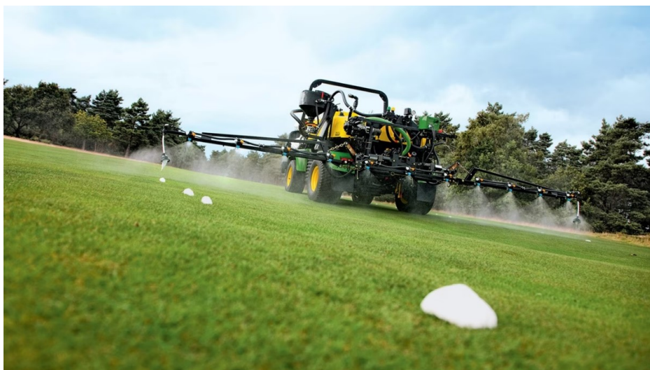
Figura 1.3: Macchina irroratrice per colture erbacee.
